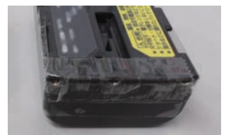
モバイルバッテリー(小型充電式電池)の絶縁処理例
