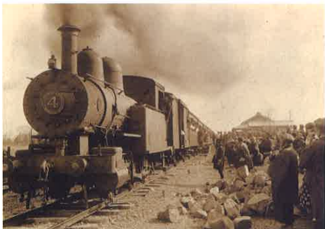
4号蒸気機関車が牽引する常総鉄道の貨客混合列車（個人蔵、写真提供もたて美術館） 下妻駅での撮影です。4号機関車はアメリカのクック社製で、常総鉄道開業時の4両の機関車の1両です。同型の3号とともに近江鉄道から購入しました。
