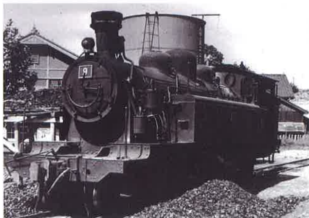
9号蒸気機関車（関東鉄道株式会社所蔵） 9号機関車は8号と共に常総鉄道が汽車会社に発注した2両の機関車の1両です。大正時代後期から昭和戦前期にかけて、常総鉄道は自社発注の機関車を5両有しました。これは常総鉄道が順調な発展を遂げた証です。
