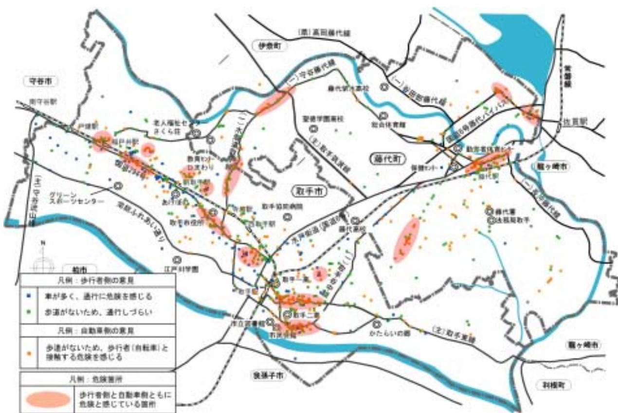
図-3.21 「車」・「人」の視点から見た取手市内・藤代町内の危険箇所
